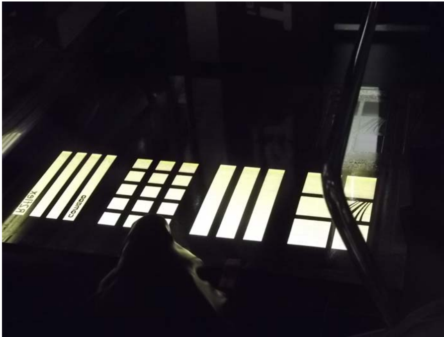
Weißer OLED auf flexiblem Metallband
